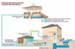
Diagrama de captació de les aigües del Ripoll
